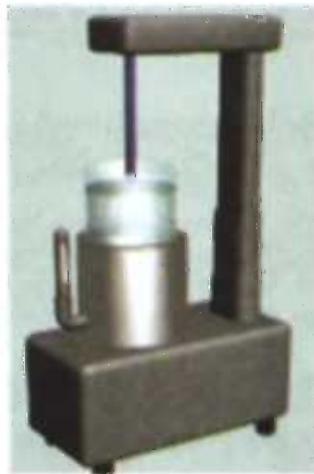
სურ. 11.20. ხელსაწყო მგრუნავი კალათა. ნაჩივნივია მგრუნავი კალათის ტიპის დანადგარი, რომლითაც ისაზღვრება გახსნის სიჩქარე.
