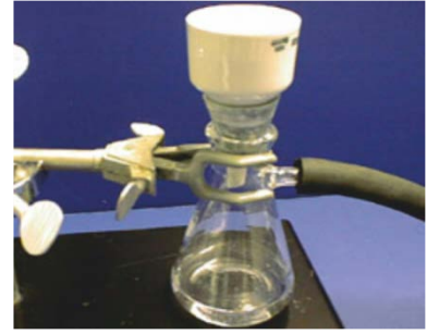
8. დავაკვირდეთ, რომ ვაკუუმ-ტუმბო ფილტრის გავლით ინოვს ჰაერს. წინააღმდეგ შემთხვევაში შევასწოროთ შეერთება კოლბასა და ძაბრს შორის
