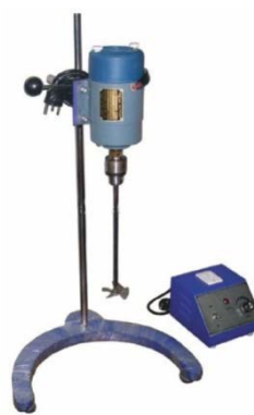
სურათი 3.9. მექანიკური სარეველა. მორევა წარმოებს ელექტროძრავასთან მიერთებული მინის ან უჟანგავი ფოლადის სარეველით
